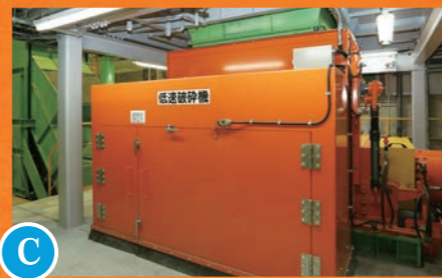
C 低速破碎機 二つの軸と破碎刃のゆっくりした回転により、ごみを細かく砕きます。
