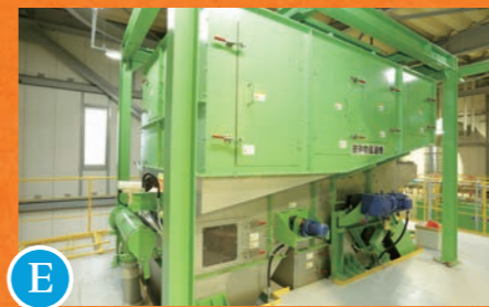
E 破碎物磁選機 磁力により破碎物から鉄類を取り出します。
