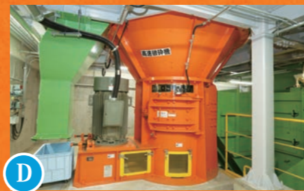
D 高速破碎機 衝撃、せん断、圧縮などの複合破碎により、ごみを細かく破碎します。
