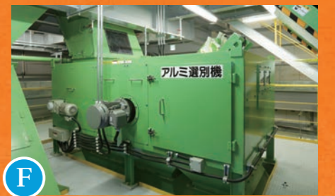
F アルミ選別機 磁石とアルミの反発を利用し、アルミ類を選別します。
